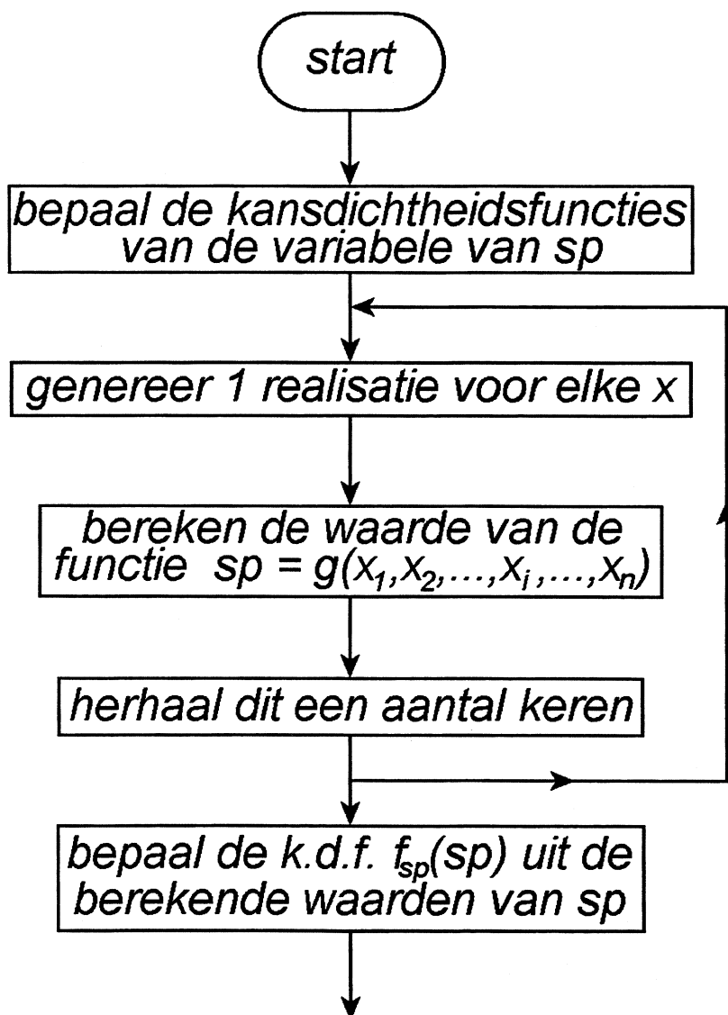
Figuur 6.11: Schema voor het uitvoeren van de Monte Carlo methode voor het berekenen van f_{sp}(sp) .
